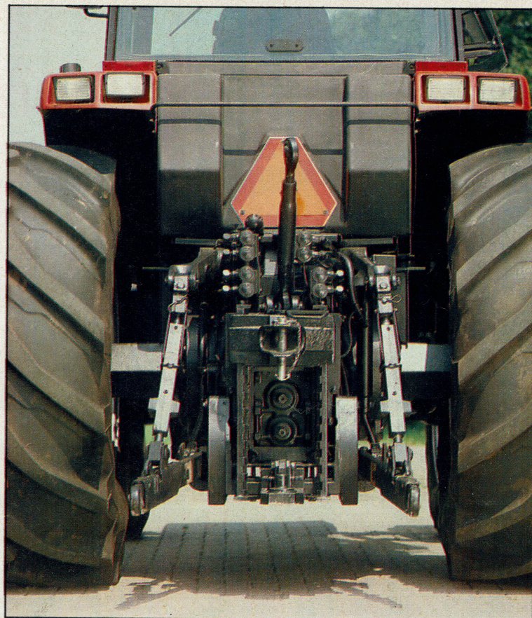
De Taurus-banden (30.5 x 32) versterken het imposante uiterlijk van de trekker. De standaardbandenmaat is 20.8 R 38. In de achterwand bevindt zich de brandstoftank. Die wordt gevuld via de opening links op het spatbord
