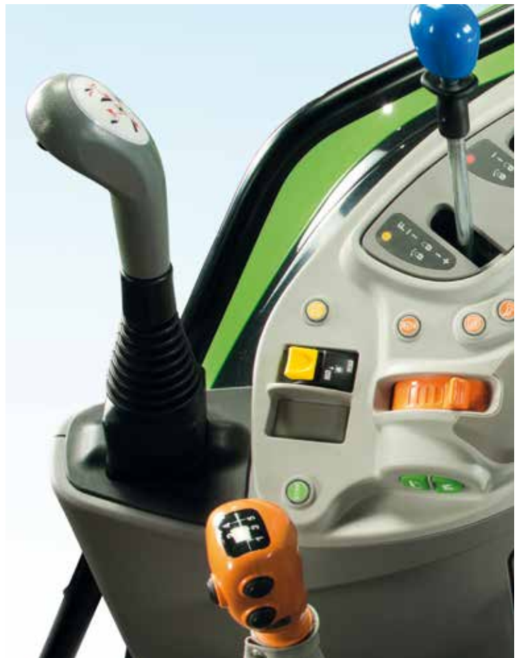
Joystick voor bediening van de frontlader, perfect in de rechter console geïntegreerd.
