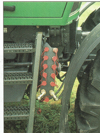
Rechts voor onder de cabine bevinden zich aansluitingen voor de externe hydrauliek
