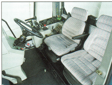
De cabine heeft aan alle zijden veel glas en is standaard uitgevoerd met twee zittingen
