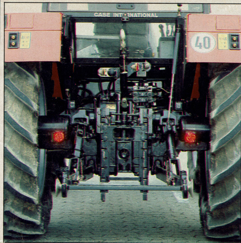
Case Maxxum 5140 heeft een robuust uitgevoerde hefinrichting die maximaal 5.250 kg tilt. Van buitenaf is de elektronische hef goed bedienbaar met drukknoppen op de spatborden
