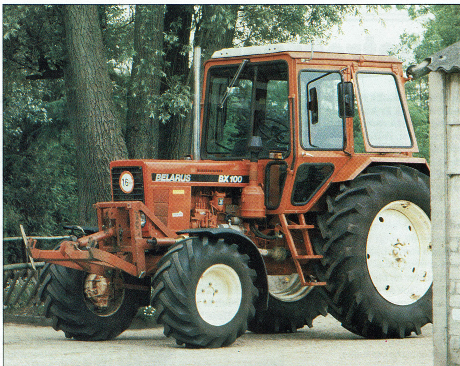
De Belarus BX 100 van de Maatschap Van der Meer is ten behoeve van het maaien met frontmaaier voorzien van brede voorbanden, een hef en een aftakas
