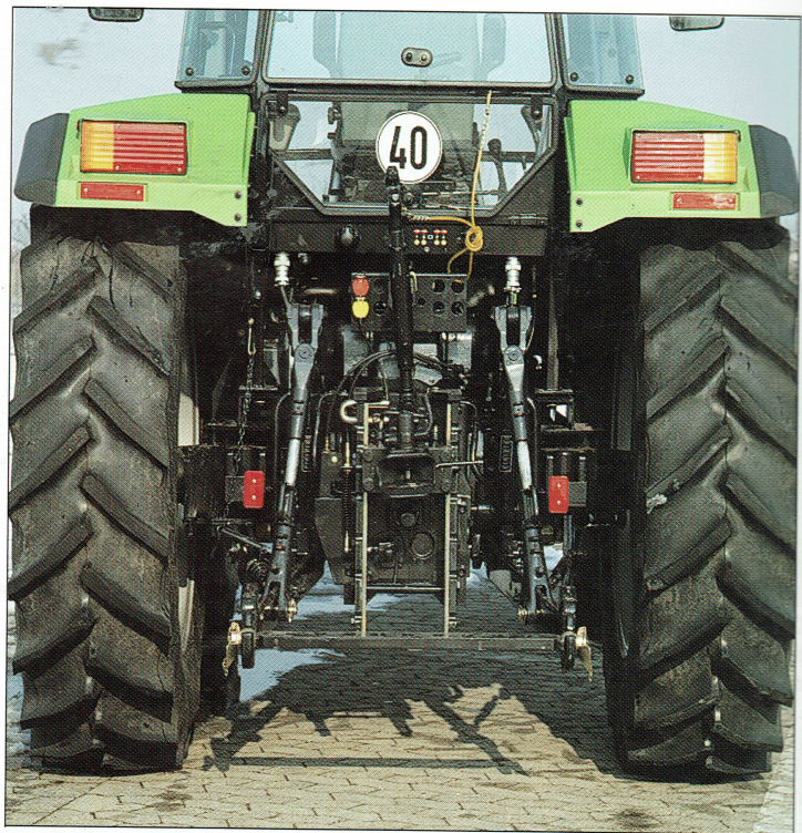
Uitgaande van Deutz-Fahr's fabrieksopgave, schiet de hefinrichting 800 kg hefvermogen tekort. Toch is de 5689 kg (door het hele traject), die hij volgens de OECD-meting maximaal kan tillen, al een respectabele prestatie
