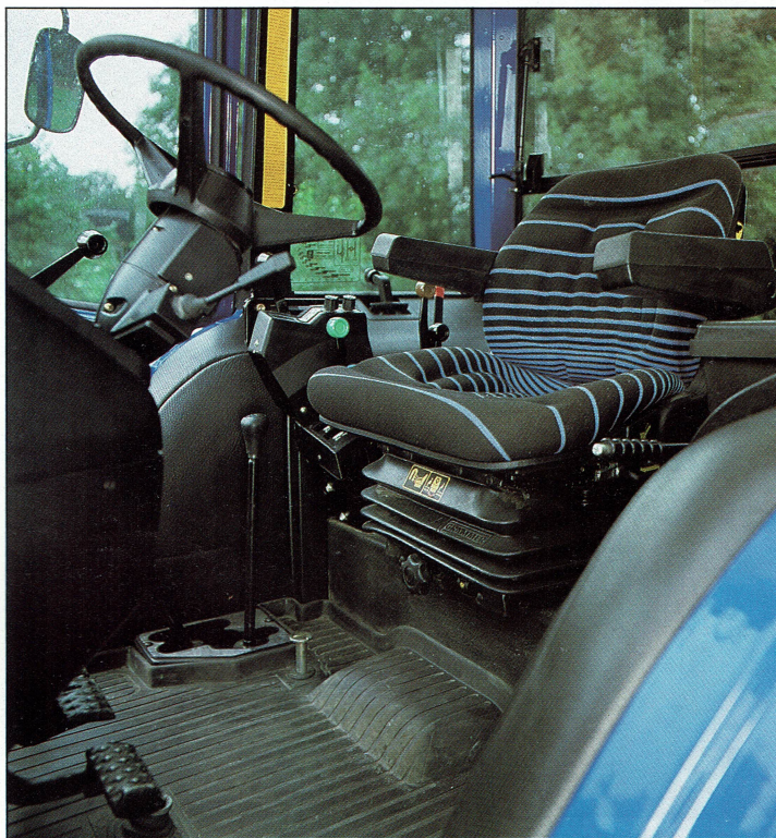
De combinatie van zwart en donkerblauw maakt de cabine vrij somber. De stoel vormt daarop een positieve uitzondering. Op de handrem na, die links van de stoel zit, zitten alle andere bedieningsorganen rechts
