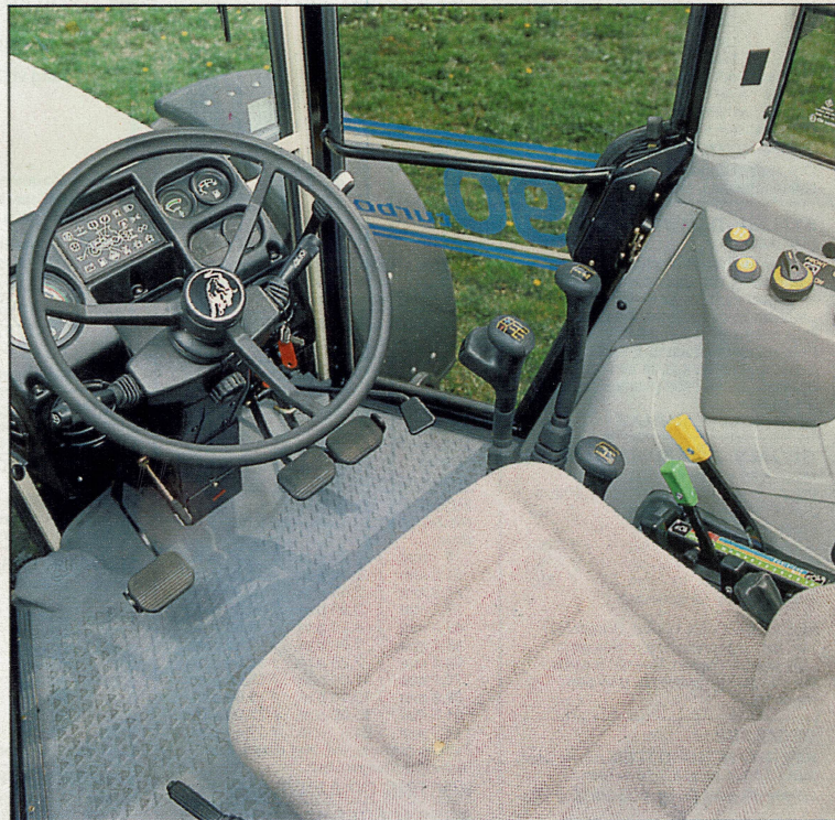
Het cabine-interieur is fraai en overzichtelijk. Rechts naast de bestuurder zitten op een goed bereikbare plaats de versnellingshendels en de bediening van aftakas, vierwielaandrijving en differentieelslot. Minder goed bereikbaar zijn hand- en voetgas
