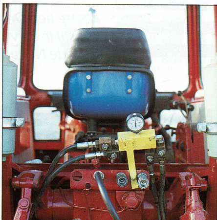
Via de trekkerhydrauliek en een manometer worden de spancilinders op de juiste druk gebracht. Twee stikstofbollen brengen een zekere soepelheid in het systeem
