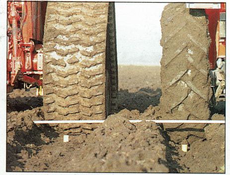
Links het verschil in insporing tussen de halftrups en de dubbellucht-montering. Rechts het verschil tussen de halftrups en enkellucht
