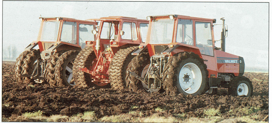
Het testteam op Eexterveense gronden. De halftrups had het minste moeite 'bovenop' te blijven; de trekker op de voorgrond lukte dat niet. De trekker met dubbellucht-montering zat er tussenin
