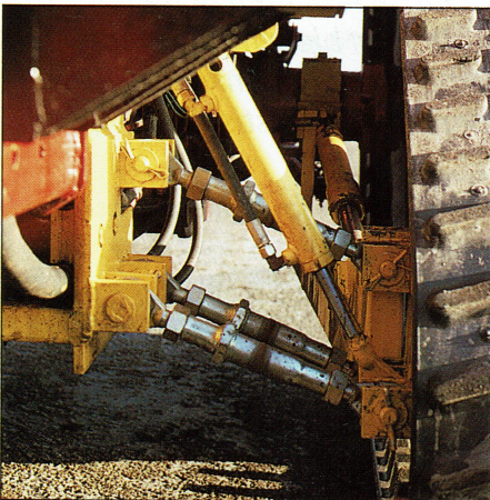
Instelbare schoorstangen brengen het geleidewiel in de juiste positie. Hydraulische cilinders houden het het op de plaats en vangen klappen op
