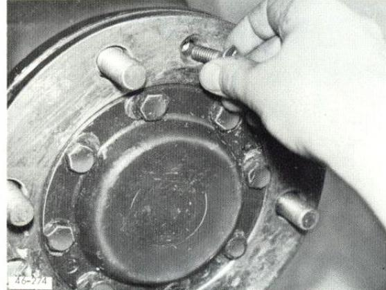
Lagerbolzen oben und unten mit Deutz F5 abschmieren. Kotflügel und Vorderrad anbauen.
