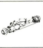
Schnittzeichnung - Angetriebene Vorderachse, Typ APL 4053
