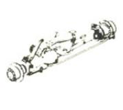
Schnittzeichnung – Angetriebene Vorderachse, Typ 3500, 3500 B, 3500 LBS, 3620
