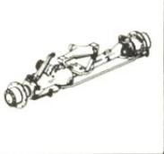
Schnittzeichnung - Angetriebene Vorderachse, Typ 5200/S, 5200/1-S, 5300
