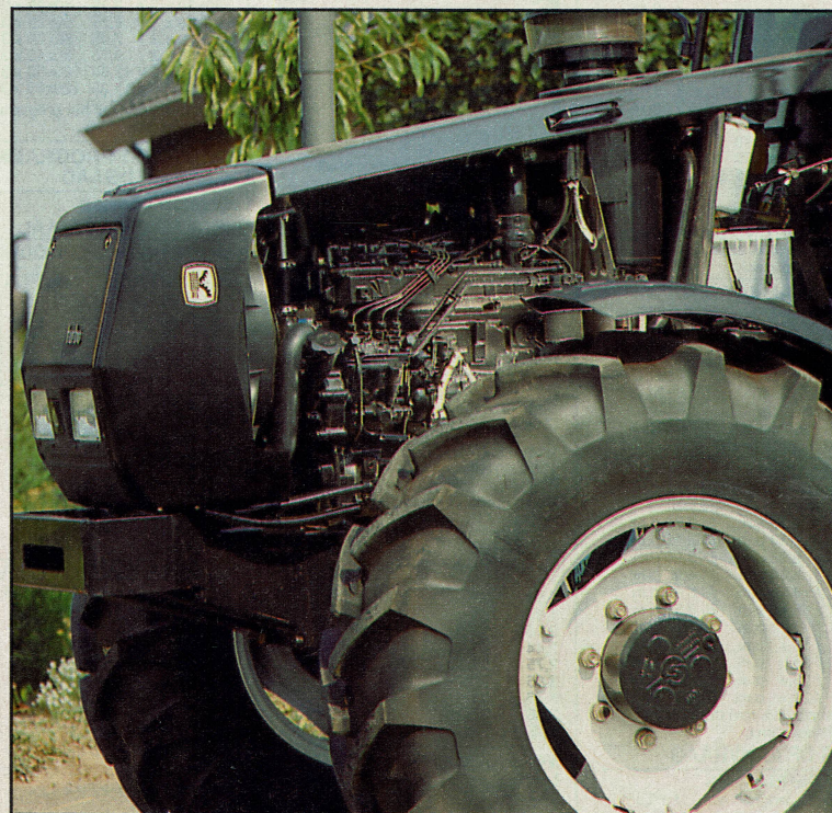
Het onderhoud levert geen echte problemen op. Voor verbetering vatbaar is het verwijderen van het zijpaneel. Nu is de kans op beschadiging groot
