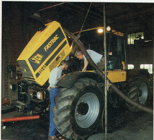
Hoe meer koppel bij tien procent toerendaling, hoe beter dat is voor aftakaswerk
