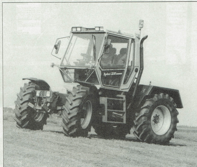
De Xylon van Fendt is gebaseerd op de GTA werktuigendrager met de cabine in het midden in plaats van achterop
