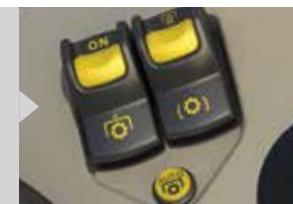
Command Centre aftakas selectieschakelaars en Auto inschakelknop.
