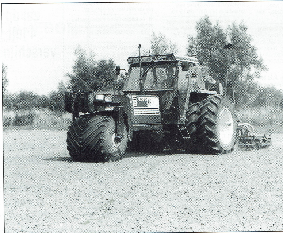
Door het brede voorwiel en dubbellucht achter ontstaat er een egaal zaaibed. Dit uit zich in een gelijktijdige opkomst van het gewas. Gele spinazieplantjes en diepe wielsporen behoren nu tot het verleden
