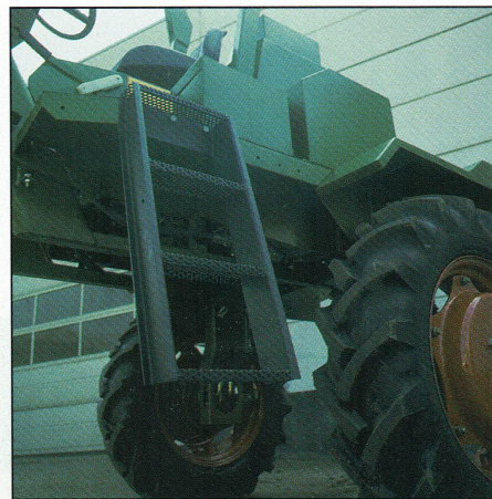
Wie op grote voet leeft, ervaart de smalle opstap van de tooltrac als een misstap
