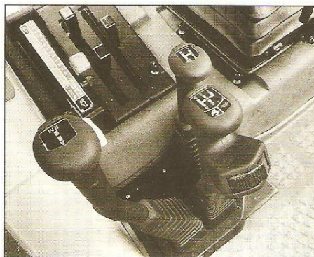
Links de omkeerschakeling; rechts de versnellingspook met vijf mogelijkheden en de onderbelasting schakelbare hoog-laag. Daarachter de pook met de vier groepen
