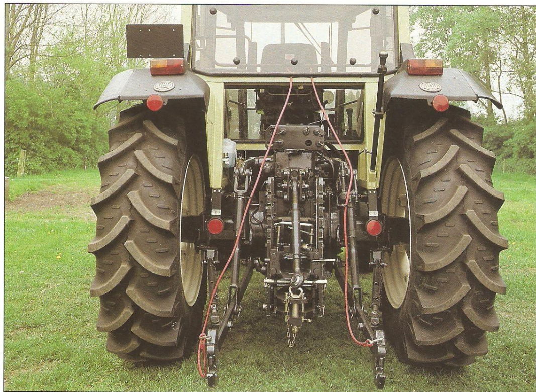
De snelkoppelingen op de trekstangen zijn standaard; op de topstang ontbreekt dit gemak. Door de onderruit is er goed zicht op de wagentrekhaak. Rechts tegen het spatbord de afstandsbediening voor de hef
