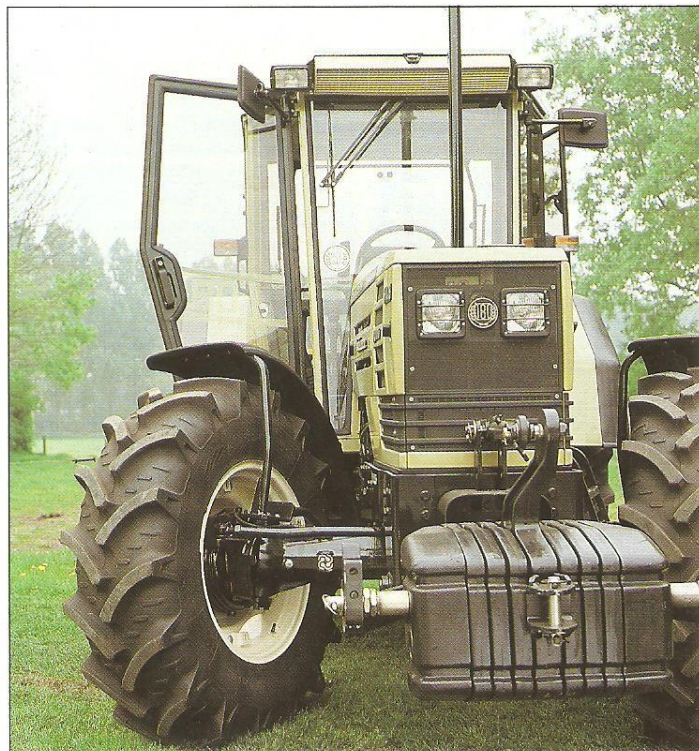
Dankzij een frontgewicht van 430 kg op ruime afstand voor de vooras, rust er bij de Hürlimann 55 % van het gewicht op de vooras. Zonder het ballastgewicht is dat percentage 45
