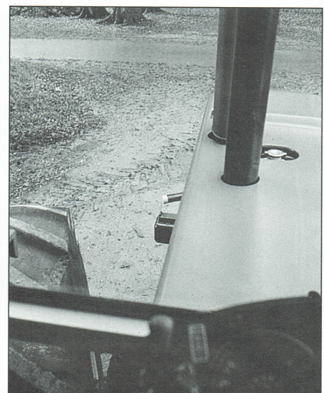
Vanaf de zitplaats is de (lege) fronthef niet te zien. Om beschadiging te voorkomen kan hierin een markeerbalk worden gehangen
