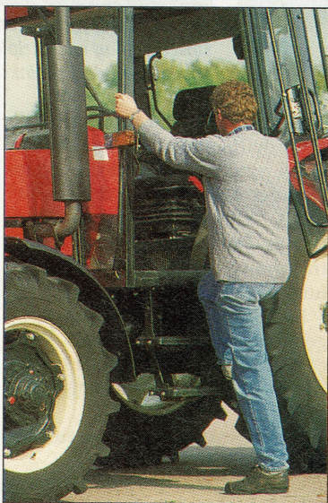
De instap is te stijl. Dit is eenvoudig op te lossen door de onderste trede om te draaien. Hier is dat gebeurd
