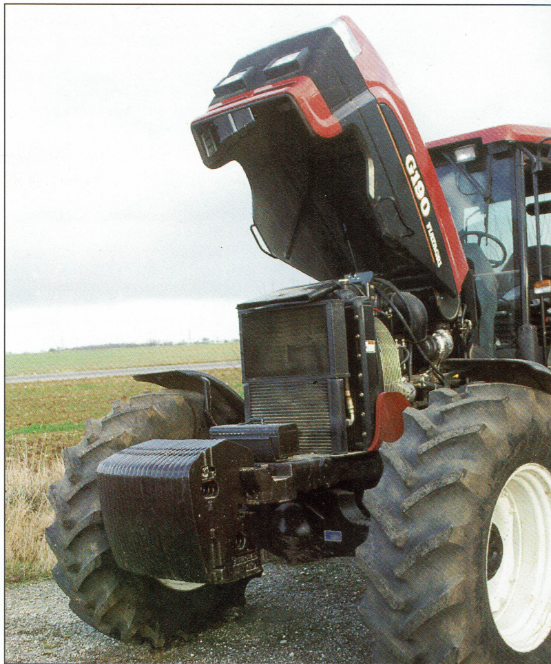
De motorkap is in zijn geheel eenvoudig opklapbaar, waardoor de motor goed toegankelijk is
