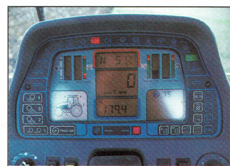
Op het digitale dashboard verschijnt alle denkbare informatie over de trekkerfuncties en de werkzaamheden die verricht worden. Een ingebouwde boordcomputer is standaard
