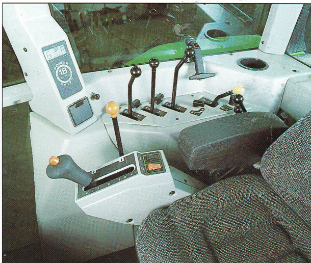
De schakelconsole zit aan de stoel vast. Op het display in de rechterzijstijl is de ingeschakelde versnelling afleesbaar
