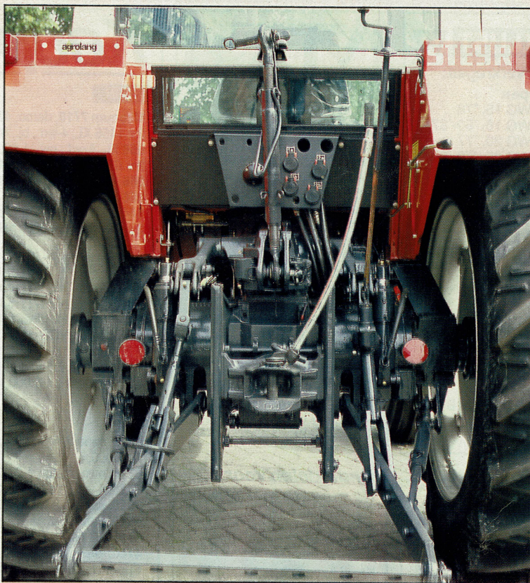
Standaard wordt deze Steyr afgeleverd met een snelverstelwagentrekhaak, gatenbalk en twee dubbelwerkende ventielen. Om zijn hefvermogen te vergroten, heeft men de hefinrichting voorzien van twee extra hulpcilinders
