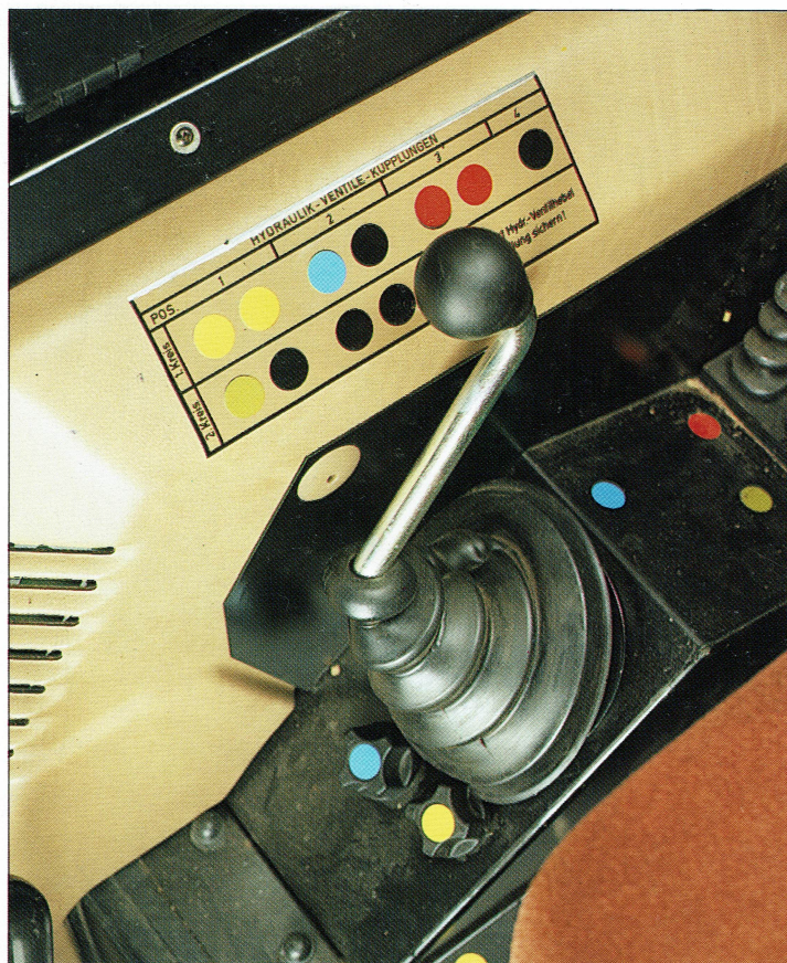
Met de gecombineerde hydrauliekhendel zijn twee stuurventielen te bedienen. Met draaiknoppen (blauw en geel) zijn de ventielen die je niet nodig hebt te blokkeren
