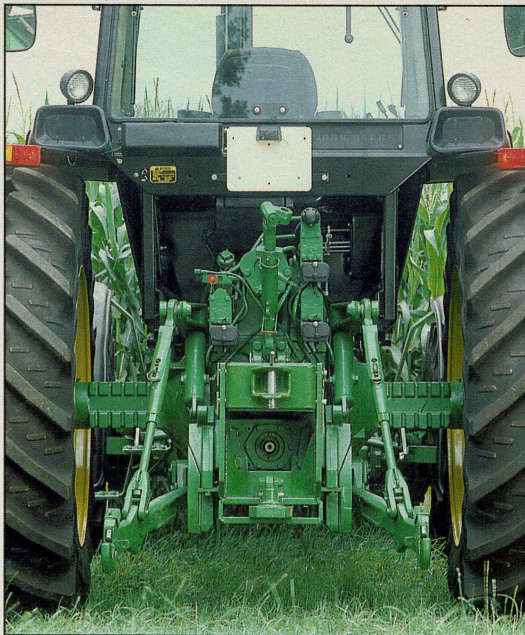
Drie dubbelwerkende stuurschuiven met doorstroomregeling zijn standaard, evenals snelkoppelingen op de trekstangen. Op de topstang ontbreekt dit gemak. De spoorbreedte is over een groot traject traploos instelbaar
