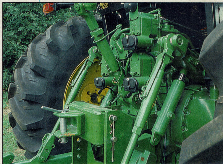
De lengteverstelling van de hefstangen is onpraktisch: je hebt er een grote steeksleutel voor nodig. Ondanks de toepassing van twee hulphcilinders (onder iedere hefarm een) valt de hefkracht tegen
