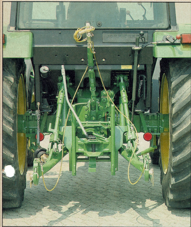
De hefinrichting is robuust en degelijk uitgevoerd, met goed verstelbare hef- stangen. Een snelverstelrekhak is als extra leverbaar. Standaard zitten er twee dubbelwerkende ventielen op deze trekker
