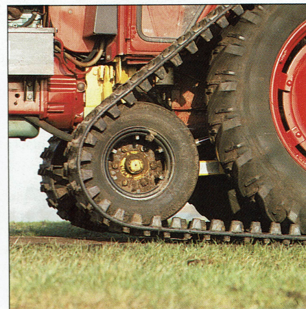
De rupsband ligt aan de voorzijde drie centimeter hoger dan onder het achterwiel. Dit maakt het mogelijk zonder al te veel problemen een scherpe bocht te maken
