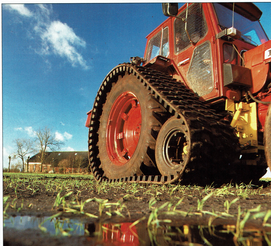
Plassen op het land hoeven de slagvaardigheid van boer of loonwerker niet meer in de weg te staan als de trekker is uitgevoerd als halfrups
