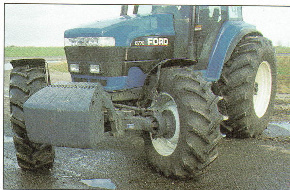
Bij de uitvoering met een 'Super Steer'-as is een wieluitslag van max. 65° haalbaar. De minimale draaicirkel bedraagt bij dit model 9,10 m
