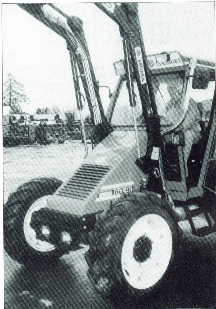
Een gewone Fiat 60-90 trekker, maar met een schuine motor-kap. Voor deze verandering moest de radiator worden ver-plaatst en een elektrische ventilator aangebracht
