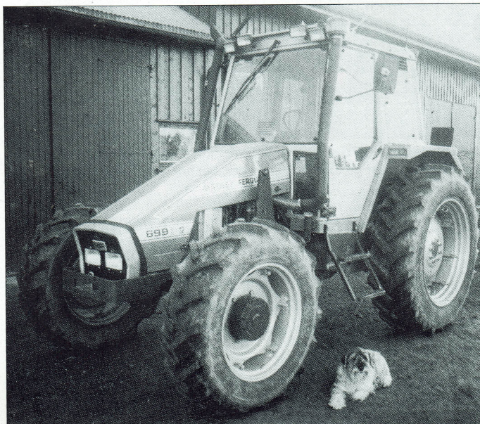
De radiator van deze aangepaste Massey Ferguson 699 is naar achteren geplaatst. Hierbij moest de V-snaar-aangedreven ventilator worden vervangen door een ventilator met een elek-tromotor
