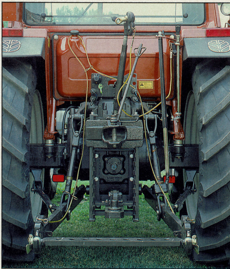
De snelverstel wagentrekhaak, de kipperknobbel, de gatenbalk en de snelkoppelingen op de trekstangen en topstang zijn bij de standaardprijs inbegrepen. Dat geldt ook voor de afstandsbediening voor de hef. Deze zit aan de binnenzijde van het rechter spatbord en is dus niet tweezijdig te bedienen
