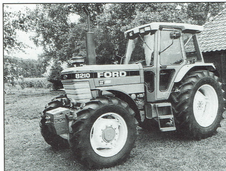
De Ford 8210 is fors gebouwd. Qua afmetingen kon deze trekker ook wel 150 pk herbergen. Het hoogste punt van het cabinedak zit op 289 cm. De uitlaat steekt daar nog weer 16 cm bovenuit, maar daar is wel iets aan te doen
