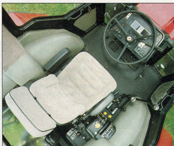
De 856 heeft ook een moderne cabine en digitaal dashboard. Het geluidsniveau ligt met 81,5 dB(A) boven de grens van 80, voor een 'goedkope oude' trekker is dit respectabel, vooral omdat de motor een heerlijke Inter-sound produceert
