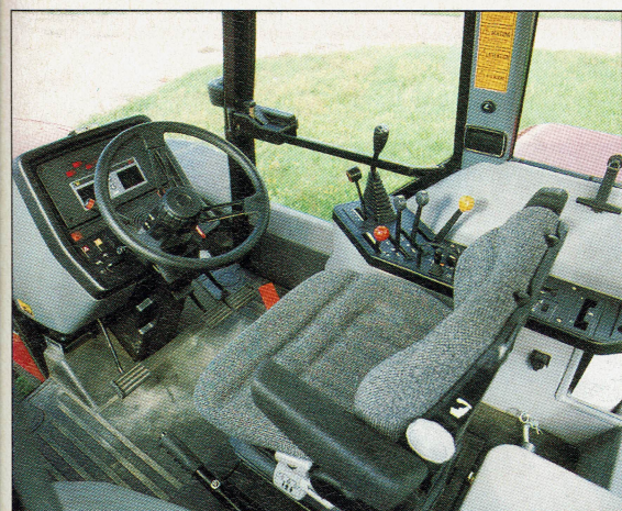
De Maxxum heeft een digitaal dashboard en een horizontaal en verticaal verstelbaar stuur. Voor een moderne trekker viel het geluidsniveau met 79,5 dB(A) wat tegen
