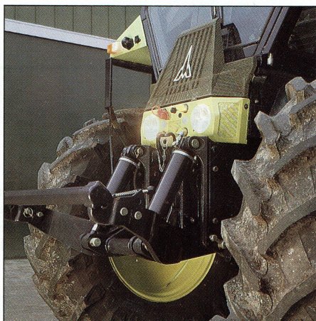
De frontheef heeft een hefkracht van viereenhalf ton. De bediening loopt normaal via een stuurventiel maar kan ook lopen via de elektronische sturing van de achter-hef
