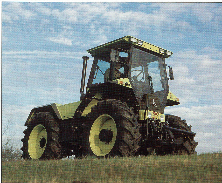
Zonder twijfel een zeer afwijkende vormgeving; je mist de motorkap. De bestuurder zit net zoals bij een vrachtwagen boven de motor. Achter de kabine zit een forse opbouw-ruimte
