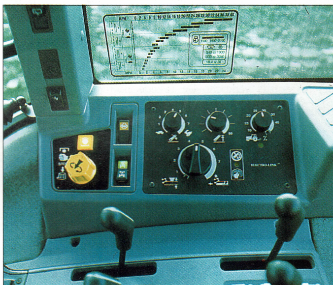
Rechts is het bedieningspaneel voor de hefinrichting te zien. De hendel voor heffen en dalen is hier niet in beeld. Deze zit vlak naast de stoel. Links zit de gele knop voor de aftakas. Aan het lampje is te zien dat deze in werking is. Linksboven de knop is ook de afbeelding van de vuist te zien die aangeeft hoe je de aftakas uit moet schakelen: met een slag
