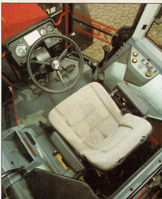
De cabines van de Aster (links) en de Explorer. Die van de Explorer is comfortabeler. Dit is vooral goed te zien aan de ongelijke vloer en de centraal geplaatste versnellingshendels bij de Aster en de gladde vloer en rechts geplaatste versnellingshendels bij de Explorer. Het geluidsniveau is bij beide te hoog
