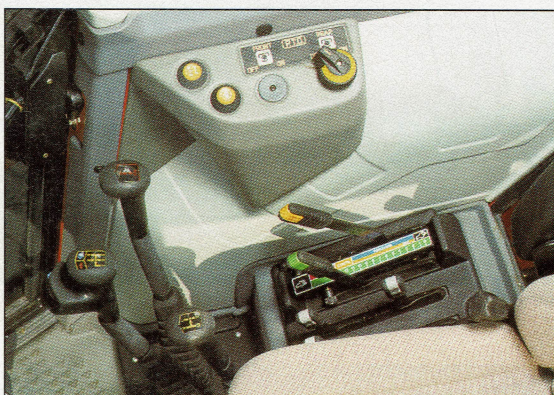
De Aster (links) en de Explorer hebben een mechanische hef. De bediening is logisch en eenvoudig. Die van de Aster is moeilijk in kleine stapjes te heffen. Bij de Explorer kan dit wel, maar daar reageert de hef te traag. De hydrauliekhendels zitten bij beide wat krap
