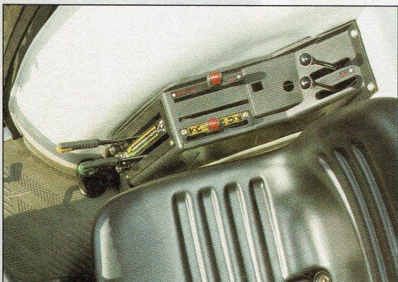
De Aster (links) en de Explorer hebben een mechanische hef. De bediening is logisch en eenvoudig. Die van de Aster is moeilijk in kleine stapjes te heffen. Bij de Explorer kan dit wel, maar daar reageert de hef te traag. De hydrauliekhendels zitten bij beide wat krap
