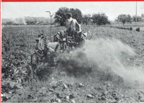
511 au travail tirant un arrache-pommes de terre rotatif
