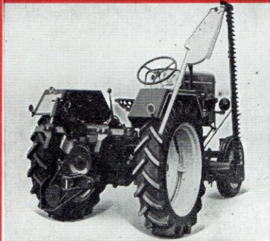
Tracteur 512 équipé d'une barre de coupe entre roues (1 m 37)
