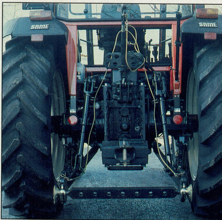
De snelverstel-wagentrekhaak, de snelkoppelingen op de hef en de gatenbalk zijn standaard. Via de grote achter-onderruit is er goed zicht op de hefinrichting
