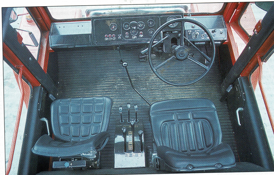
Ruim plaats voor twee personen, het stuurwiel rechts en grote bedieningshendels, maar weinig zicht op het werk: dit zijn de belangrijkste kenmerken van de cabine
