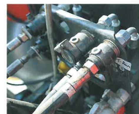
Voor het aankoppelen van dikkere slangen – zoals de retour slang – moet je eerst de beschermklepjes verwijderen. De duiding van de ventielen is helder, maar de stickers zijn niet duurzaam.
