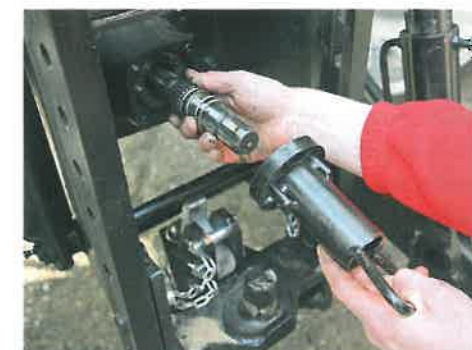
Wisselen van 540 (of 540E) naar 1.000 aftakstoeren is een kwestie van de stomp omdraaien. Dat is op zich best te doen, maar niet ideaal. Vergeet dan niet naar juiste aftakstoerenteller te kijken op het dashboard. Tegen €1.200 is een toerenwisseling vanuit de cabine leverbaar.
