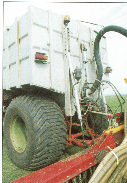
De zodebemester hangt aan de lange hangende dubbelwerkende cilinders. Onderin trekken de vrij bewegende orginele Belarus-hefarmen de zodebemester
