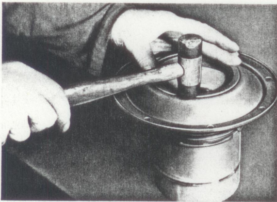
Neue BURGMANN-Dichtung einklopfen
