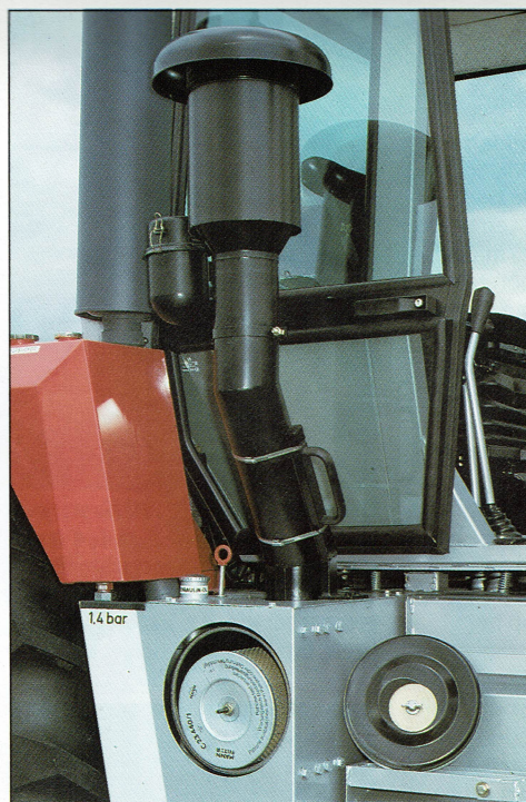
Over onderhoud is bij de Euro Trac beter nagedacht dan bij de MB-trac. Onderdelen waar je dagelijks bij moet, zoals het hier afgebeelde luchtfilter, zijn goed bereikbaar
