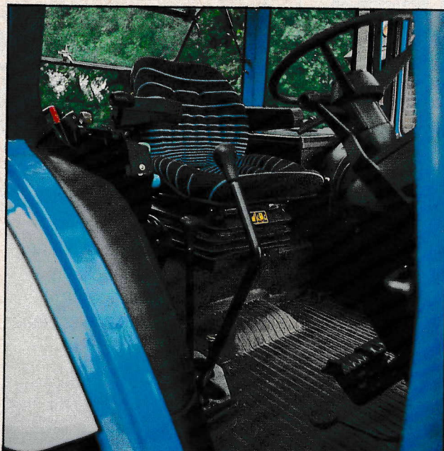
Met de versnellingspook in 1 of 3 (de afgebeelde positie) is de doorgang wat nauw. Maar in 2 of 4 valt er rechts goed in of uit te stappen. Het stuurwiel is verstelbaar. Het zebra-motief van de stoel is een frisse noot in de nogal sombere inrichting van de cabine
