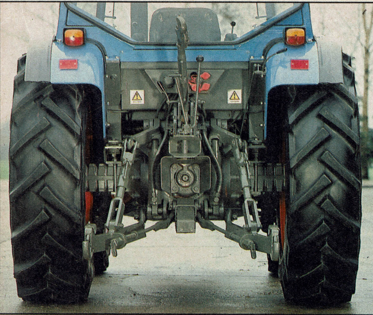
De hefinrichting is robuust uitgevoerd. Bijzonder is het blokkeermechanisme van de stabilisatie, dat zich onder de aftakas bevindt. Door de hendel naar beneden te bewegen, vergrendelen de stabilisatiestangen
