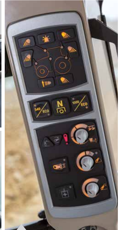
Knoppen voor aftakas toerental selectie en hefinrichting op cabine stijl.
