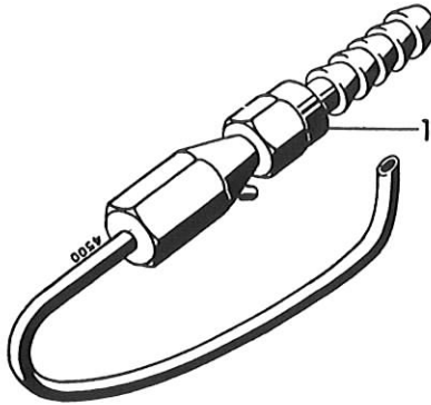
Bild 31 Kombiniertes Wasserfüll- und Ablaßventil
