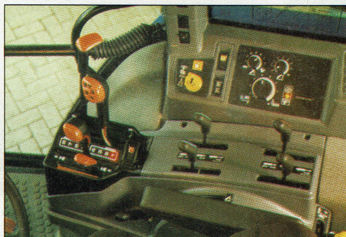
De transmissie is modern en compleet: omkeer-schakeling, kruipgroep, en vier onder belasting schakelbare mogelijkheden. De hendels zijn bere-kend op grote handen. Handig is de gele draaik-nop voor inschakeling van de aftakas. Een tik is voldoende om hem uit te schakelen
