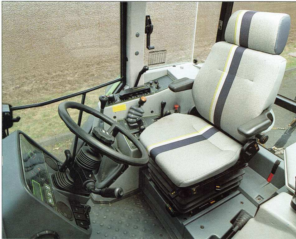
Het geluidsniveau in de trekkercabine is bijzonder laag: 73 dB(a). Daarnaast scoort de cabine goed op het gebied van ergonomie. Voor de bestuurder betekent dat een werkruimte die van alle gemakken is voorzien
