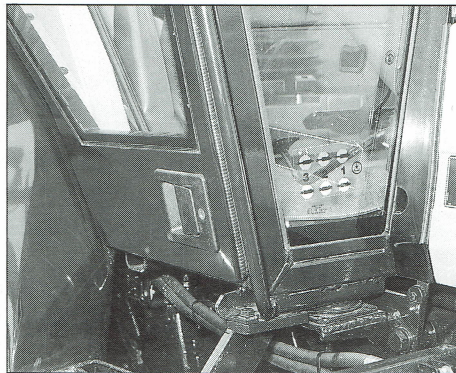
De deurkruk en het deurslot zijn prima bereikbaar. Het geheel is netjes in de onderzijde van de cabine-deur gemonteerd. Rechts op de ruit de codering voor de fronthydrauliek
