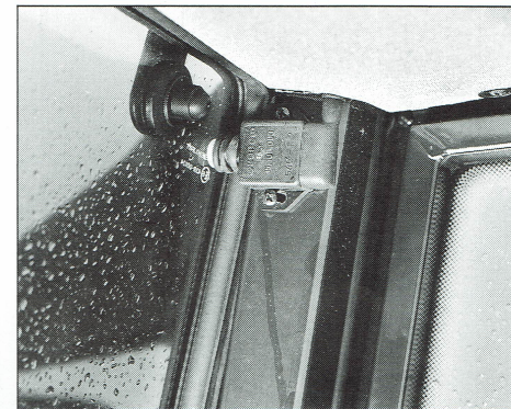
Tussen voorruit en cabineestijl zit een schakelaar. Zodra de voorruit wordt geopend verbreekt de contact en werkt de ruitenwisser niet meer. Dit om schade te voorkomen
