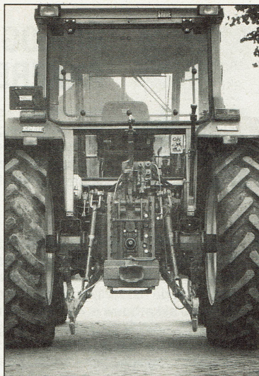
Kijkje op de achterkant van de Aster (links) en de Explorer. De Explorer is robuuster uitgevoerd, heeft een hogere hefkracht en presteert beter door het gele heftraject
