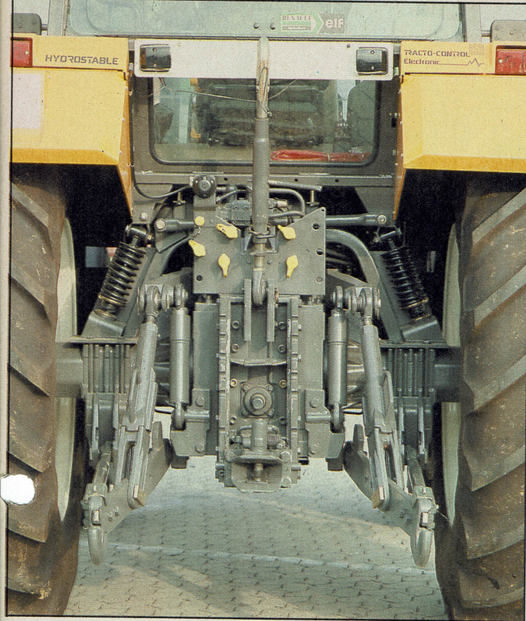
De Renault 155-54 TZ is uitgevoerd met een robuuste hefinrichting, die ruim 6.200 kg kan tillen. De veren onder de cabine maken deel uit van het 'Hydrostabile' veersysteem, waardoor de cabine als het ware zweeft
