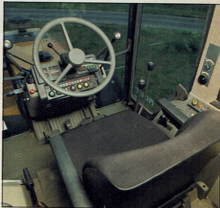
Het interieur van de TZ-cabine is ruim en overzichtelijk. Links en rechts naast het dashboard zitten de bedieningshendels voor respectievelijk hoog-laag en omkeerschakeling. Tussen koppeling en rempedalen bevindt zich het pedaal voor het differentieelslot in de achterbrug
