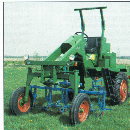
De 8200: technisch gelijk aan de 5200, alleen bodemvrijheid en gewicht verschillen
